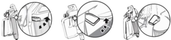
Okrenite dugme PRIME/SPRAY na PRIME. Isključite pumpu (O). Isključite prskalicu iz struje. Polako sipajte  $\frac{1}{2}$  šolje vode na vrh boje da biste sprečili sušenje boje. Umotajte sklop pištolja za prskanje u vlažnu krpu i stavite ga u plastičnu kesu. Zatvorite kesu. Postavite prskalicu na sigurno mesto van sunca za kratkotrajno skladištenje.
