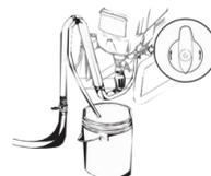
**6.** Uključite dovod vode. Uključite pumpu (I). Voda će ući u usisnu cev i izaći kroz povratnu cev. Pustite da pumpa radi nekoliko minuta kako bi se povratna cev isprala
