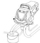
**3.** Uklonite ulazni filter iz usisne cevi i stavite ga u kontejner za otpad (ne bacajte).
