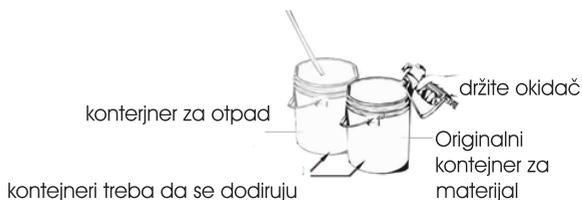
8. Dok držite okidač, okrenite dugme PRIME/SPRAY na SPRAY kako biste izbacili materijal iz creva nazad u originalni kontejner za materijal. Nastavite da držite okidač kroz sledeće korake.
